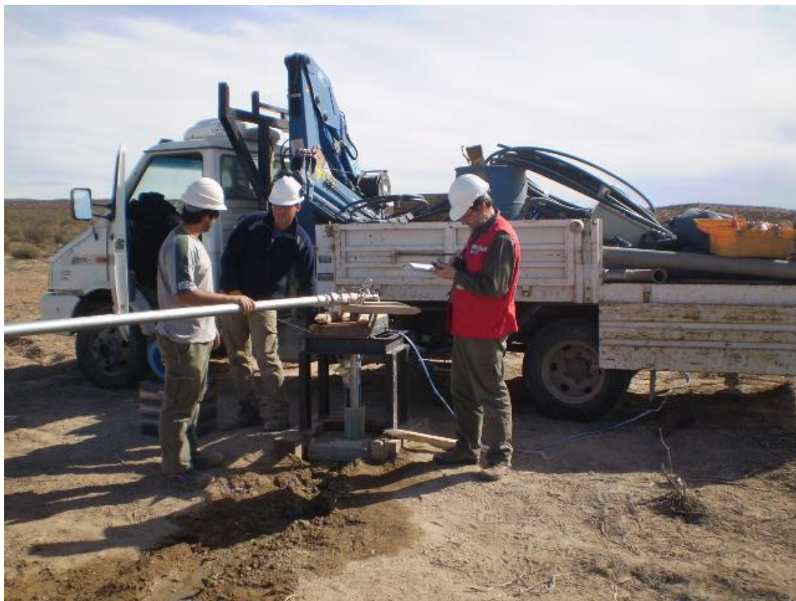
Foto 8.1: Ensayo de bombeo en Puesto Alvear.
