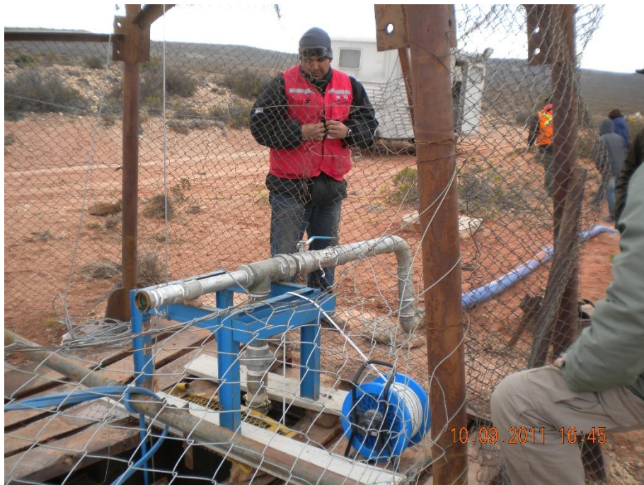
Foto 8.3: Ensayo de bombeo en El Pique (pozo de gran diámetro).
