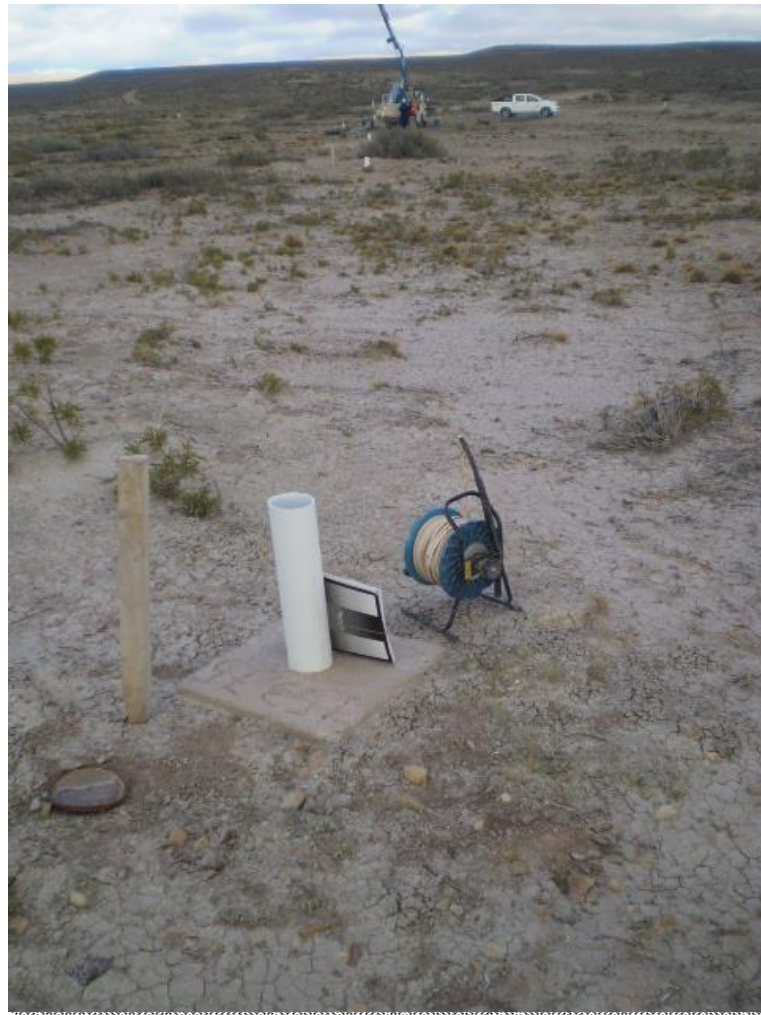
Foto 8.2: Ensayo de bombeo en El Molino (1).
