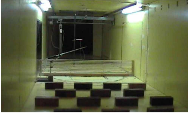
Ensayo de barreras eólicas
