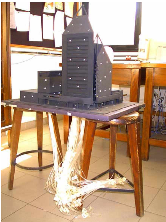
Maqueta de complejo edilicio con las tomas de presión
