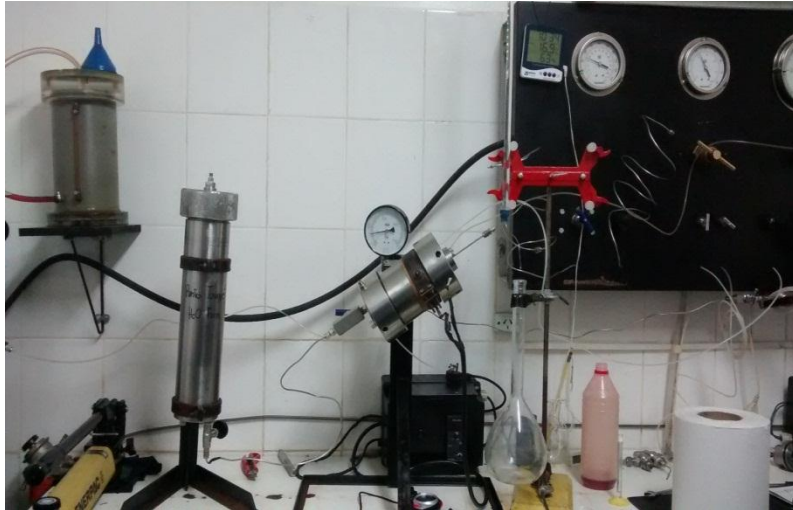
Imagen 24. Ensayo Puntos Extremos. Desplazamiento del gas con un agua de formación.
