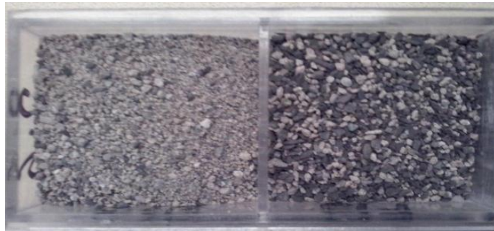
Imagen 1. Cambio litológico 509 m a 512 m.
