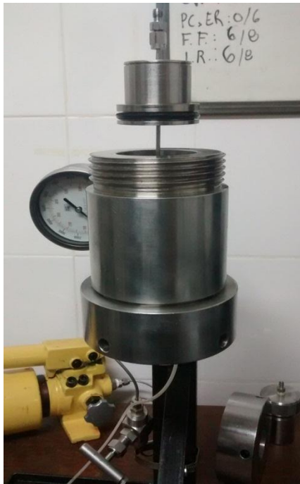
Imagen 16. Celda Triaxial para realizar ensayo de CVP.
