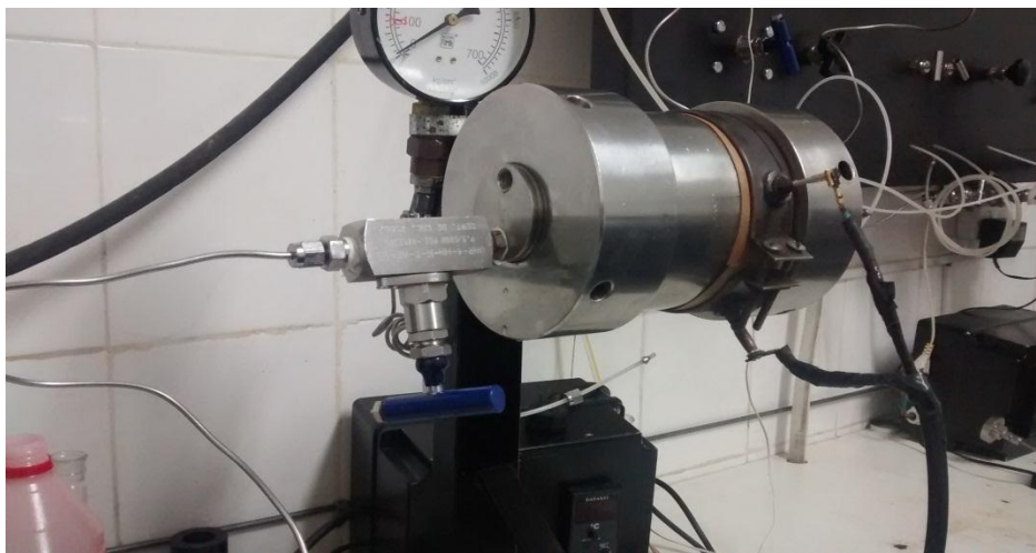
Imagen 19. Se observa el goteo en el tapón de entrada. El circuito se encuentra sin aire.
