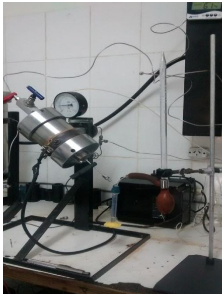
Imagen 22. Ensayo Puntos Extremos. Desplazamiento del agua con un gas.
