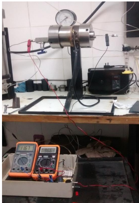
Imagen 21. Ensayo Factor de Formación con medición de resistividad.
