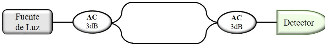
Fig. 3. 1 Esquema del interferómetro Mach- Zehnder
