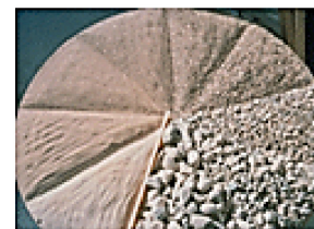
Fig. 5. 2 Agregados finos y gruesos
