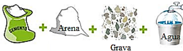
Fig. 5. 1 Mezcla de Concreto
