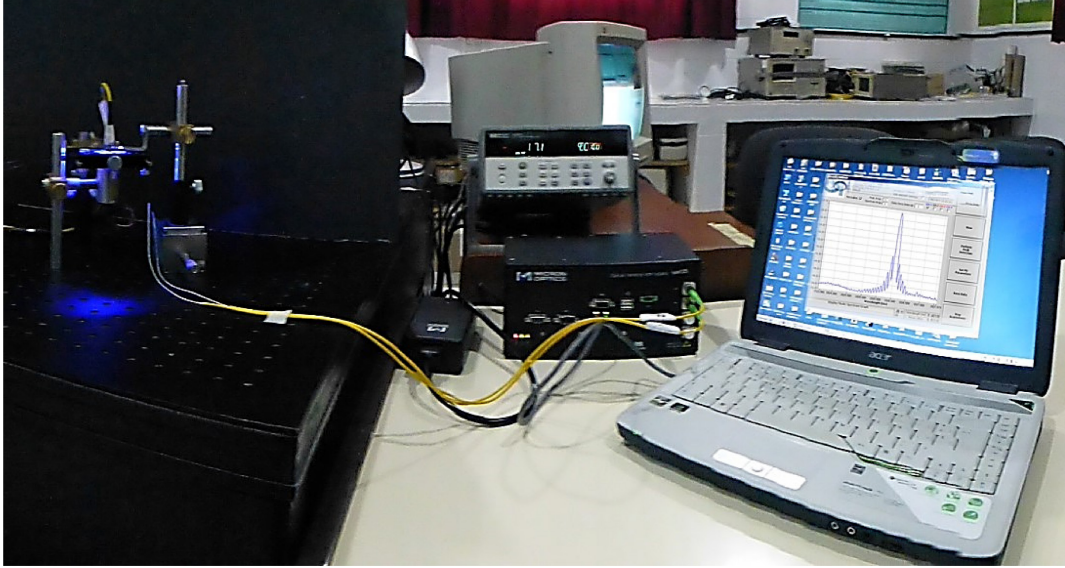
Fig. 4.13 Montaje experimental para medir deformación con una FBG embebida
