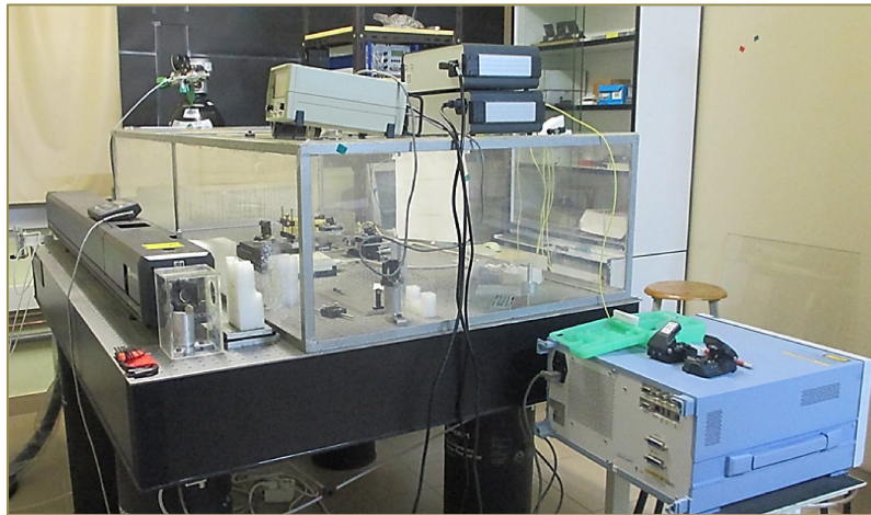
Fig. 2. 40 Montaje experimental del sistema de grabado de redes CFBG
