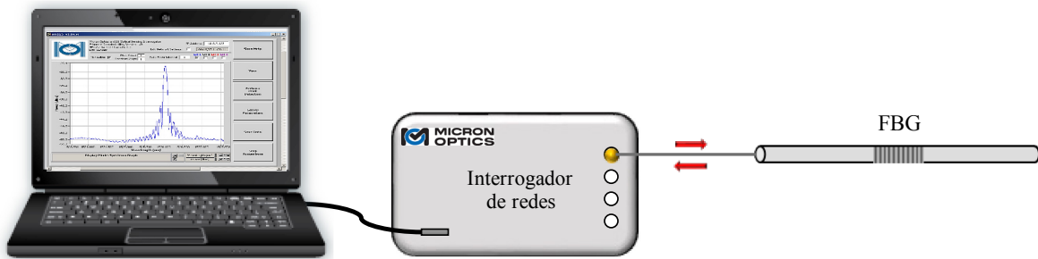
Fig. 2. 19 Esquema de medida por reflexión de una FBG con interrogador de redes
