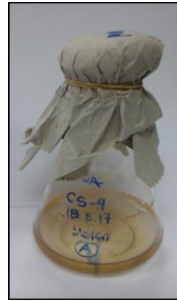
Figura V.14. Fotografía de uno de los consorcios sintéticos durante la degradación de 200 mg/L de fenantreno luego de 15 días de incubación.
