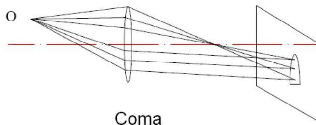
Figura 2: (Adaptado [www.lambdasys.com](http://www.lambdasys.com)) – Coma formado por meio dos feixes incidentes em uma lente esférica.
