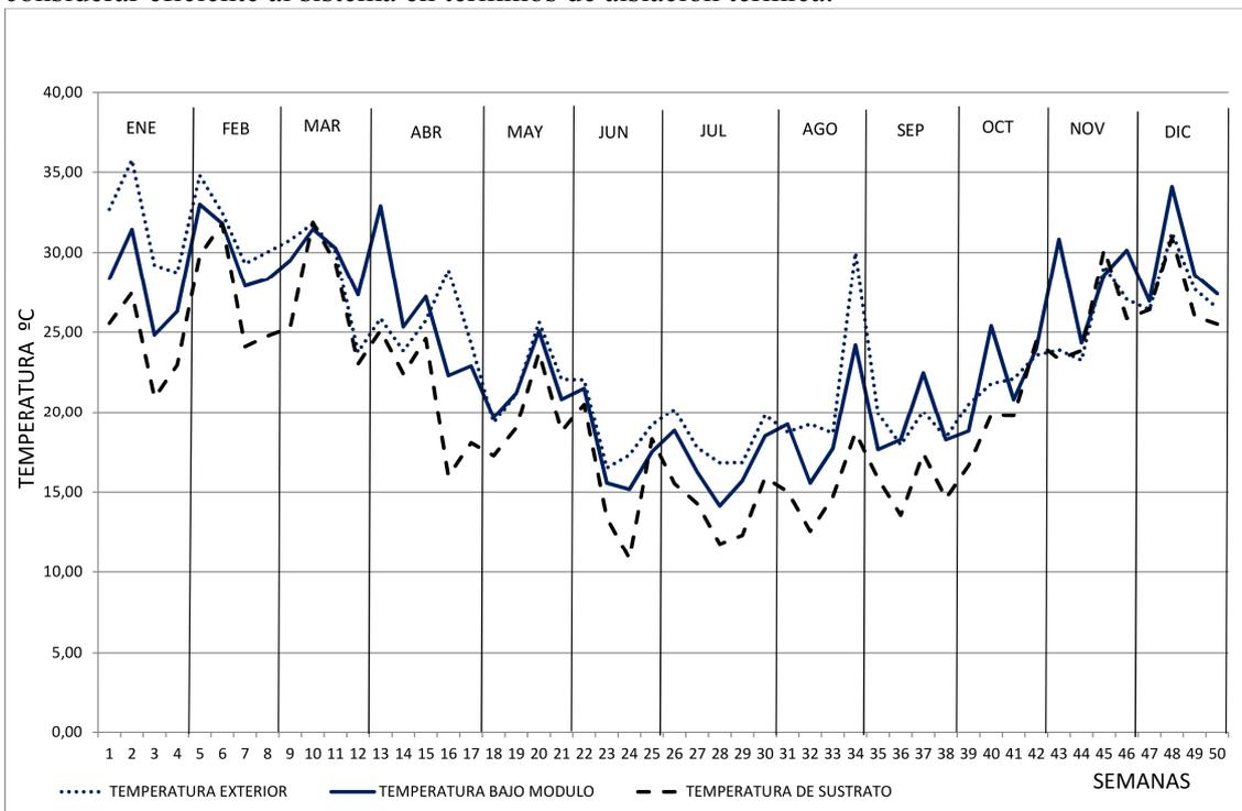
*Figura 6: Medición comparativa de temperaturas en baldosas modulares circulares de sustrato, bajo el dispositivo y temperatura ambiente exterior. Periodo: Enero 2015-Diciembre 2015.*
