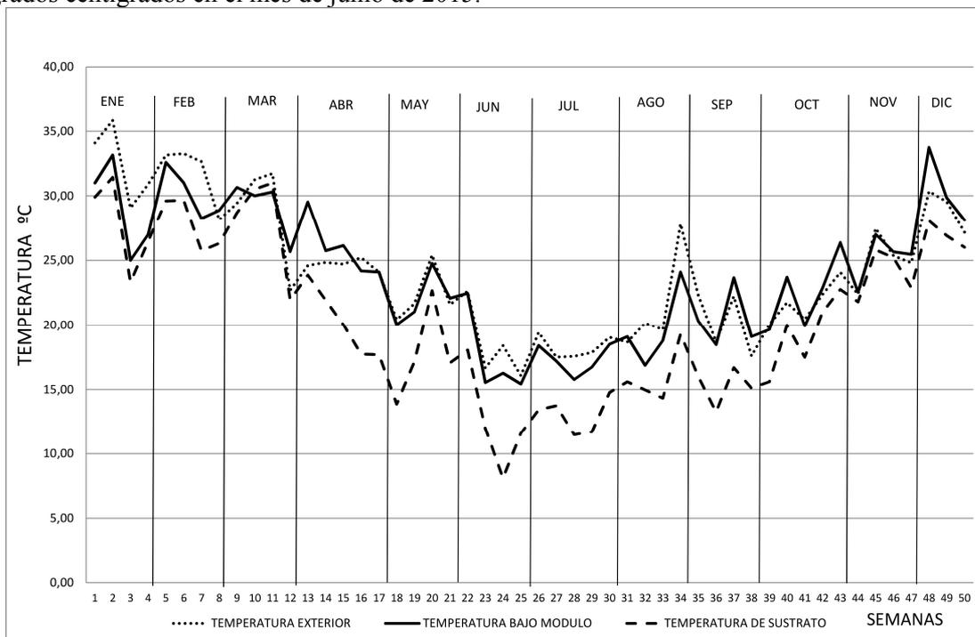
Figura 4: Medición comparativa de temperaturas en bandejas modulares de 40X60 de sustrato, bajo el dispositivo y temperatura ambiente exterior. Periodo: Enero 2015-Diciembre 2015.
