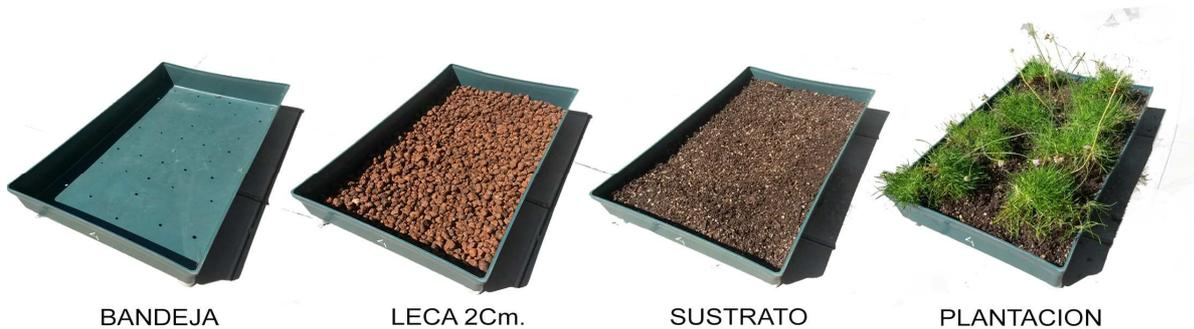
Figura 3 : Secuencia de armado de bandejas modulares de 40X60 cm<sup>2</sup>.
