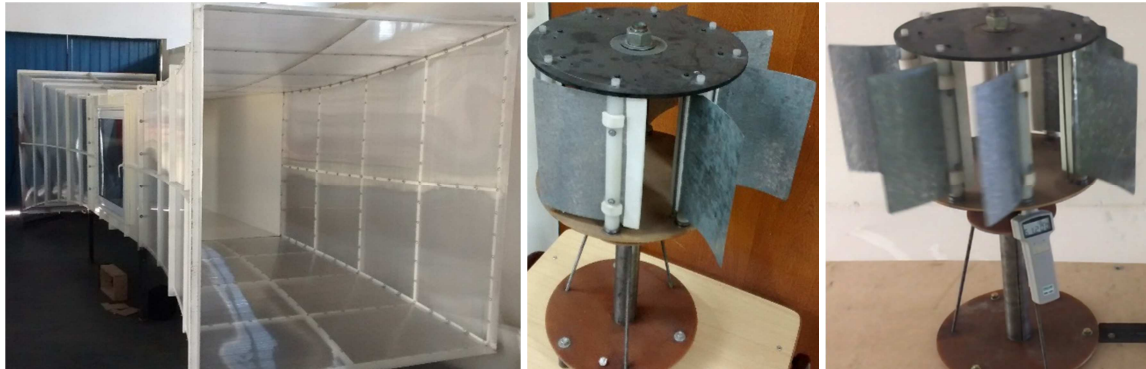
Figura N°2: Fotografías del Túnel de Viento y del prototipo del aerogenerador
