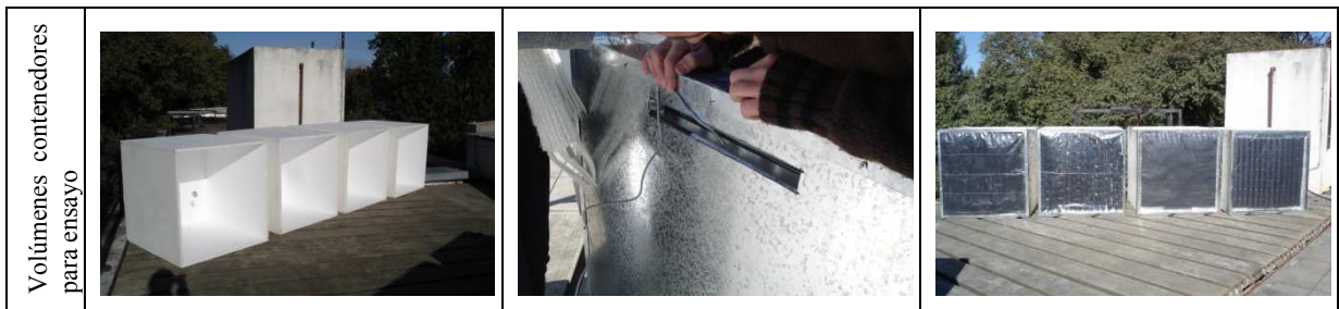
Figura 3. Montaje de las cajas para la medición de las seis probetas
