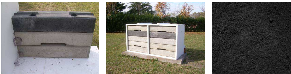
Figura 6: Pieza del MAC pigmentadas, sin pigmentar (hormigón natural) y colorante negro de humo.
