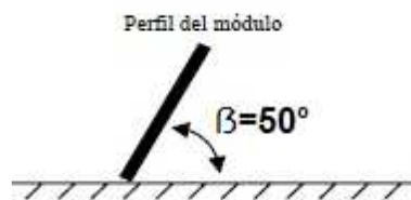
Figura 2: Angulo de inclinación del panel
