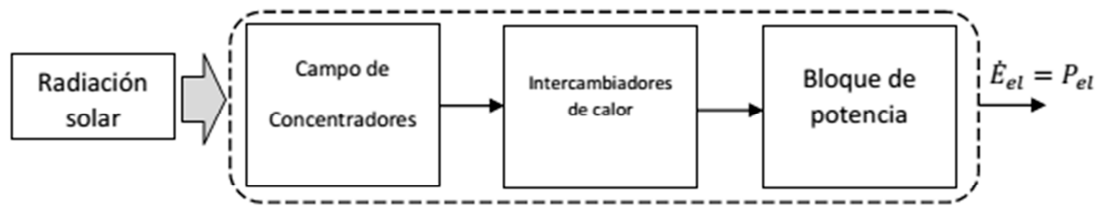
Figura 1. Esquema de los componentes de la central CSP modelada por el grupo FAE
