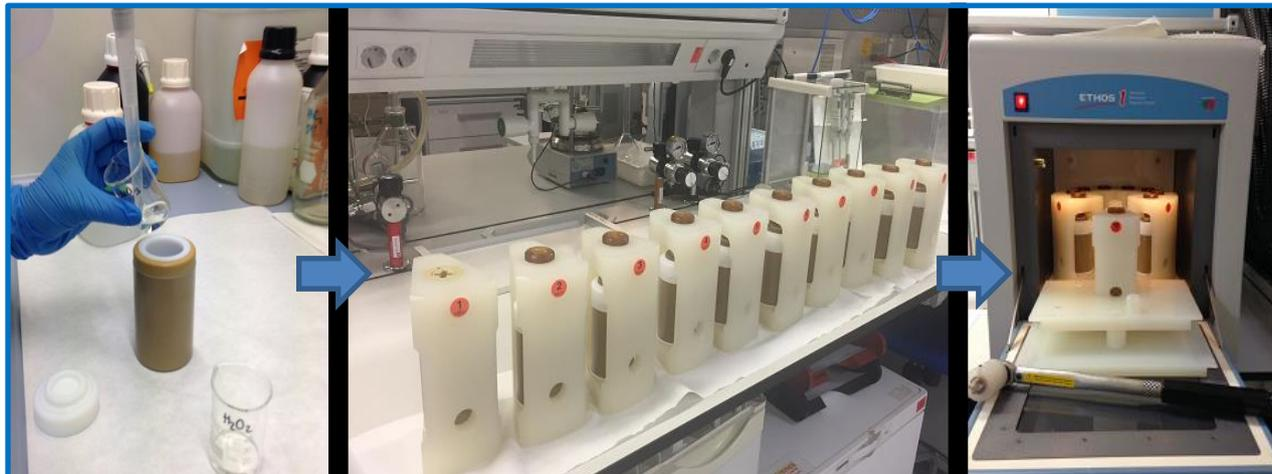
**Figura 3.2** Ensayo de digestión de muestras para determinación del contenido de minerales.
