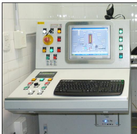
Figura 1.6. Módulo de control del equipo APH Stansted Fluid Power Ltd. High Pressure Iso-Lab System modelo FPG9400:922.
