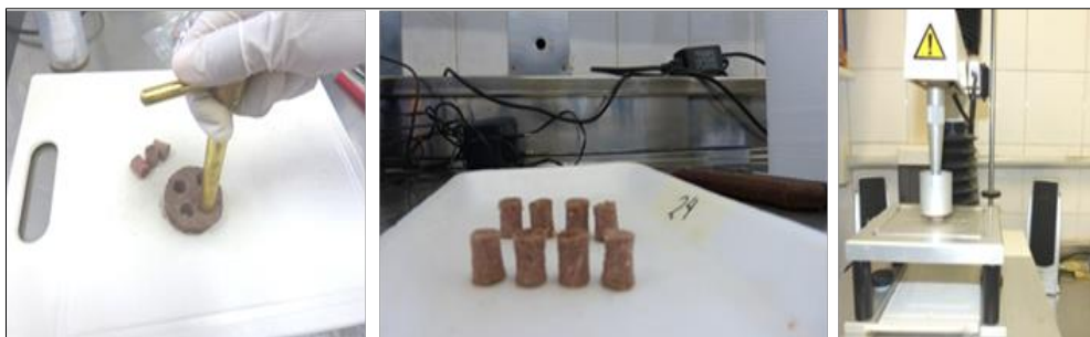
Figura 3.8. Izquierda: sacabocado para el corte de cilindros de las hamburguesas cocidas. Centro: muestras para análisis de textura obtenidas con el sacabocado. Derecha: accesorio cilíndrico y analizador de textura Stable Micro Systems modelo TA.XTplus.
