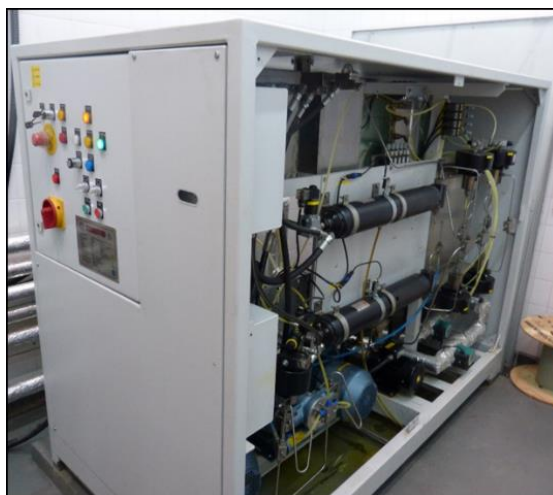
Figura 1.8. Módulo de servicio del equipo de APH Stansted Fluid Power Ltd. High Pressure Iso-Lab System modelo FPG9400:922.
