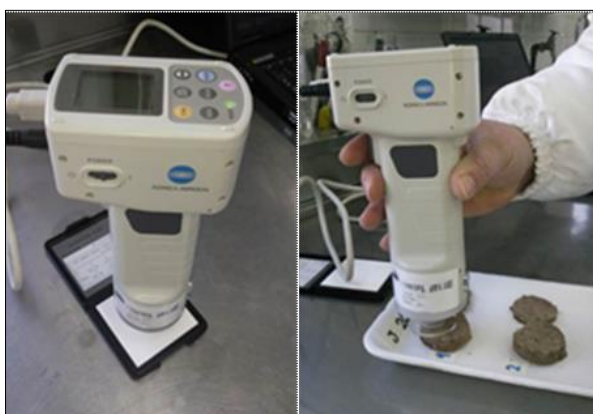
Figura 3.7. Colorímetro portátil Minolta modelo CR 400.
