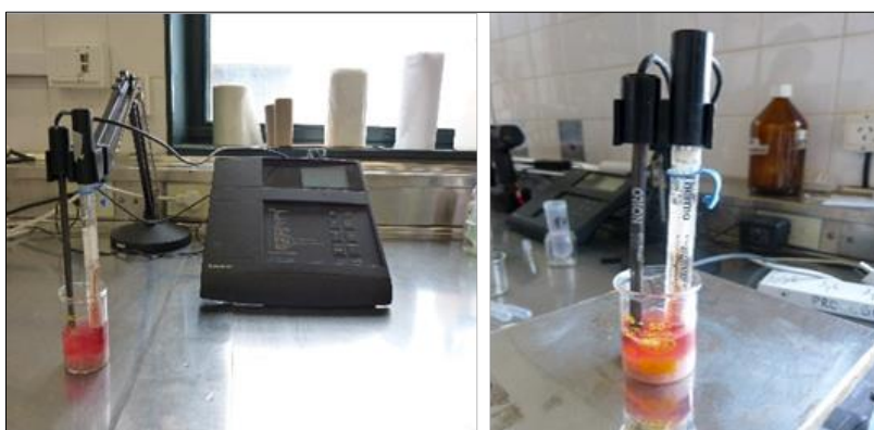
Figura 3.6. pH-metro Thermo Orion, con electrodo y sonda ATC.
