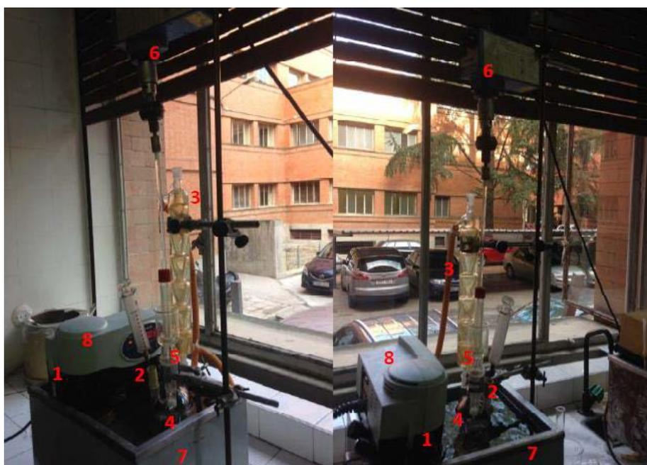
Figura 3.1. Equipo utilizado para la transesterificación: (1) termómetro, (2) sistema de toma de muestra, (3) condensador, (4) agitador de teflón, (5) motor de agitación, (7) baño de agua, (8) termostato del baño
