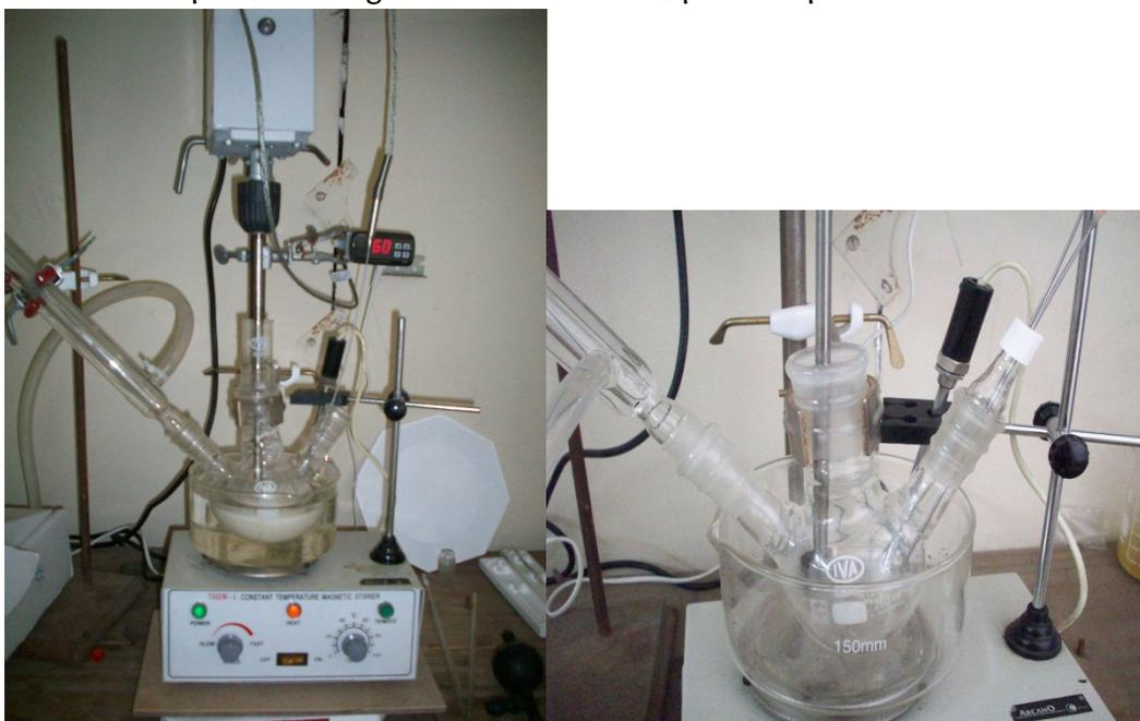
Figuras 5.19 y 5.20. Fotografías del equipo de reacción empleado para la transesterificación
