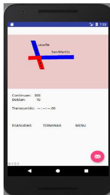
Figura 4. Aplicación Móvil. Permite la recolección de datos in-situ, y la transmisión automática al servidor.
