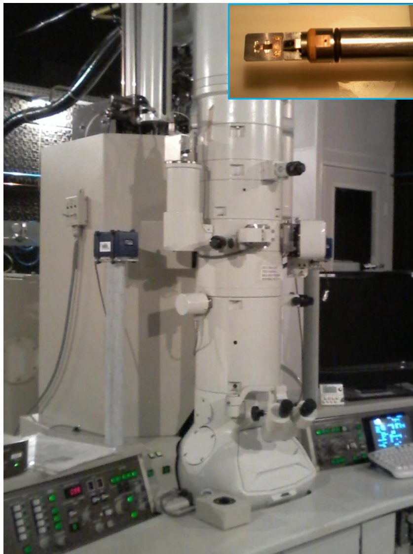
Figura 3.8: Fotografía del microscopio TEM-MS JEOL 2100 usado para adquirir las imágenes TEM. En el recuadro se presenta la preparación de la muestra.
