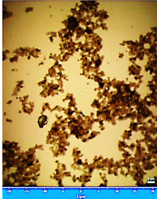
Figura 5.10: Imagen tomada con el microscopio óptico con un objetivo de 100× de una gota diluida del coloide de NPs de Fe sintetizado por FLASiS en agua. La barra de escala es de 2 µm.
