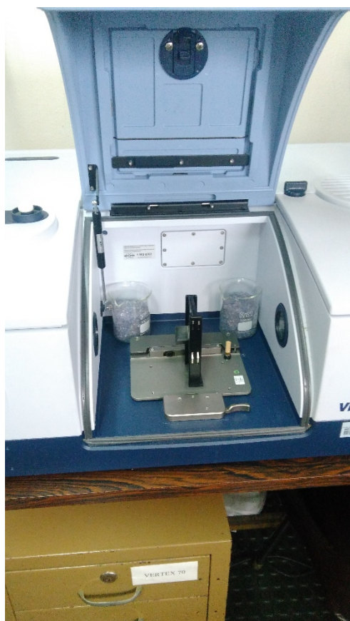
Figura 20. A Equipo de FTIR. B Detalle de la celda y la platina. C Espectro infrarrojo. Gentileza: Jorge Sambeth y Graciela Valle. CINDECA
