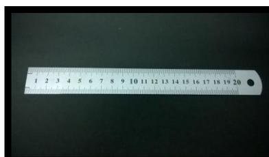
Fig. 11: Regla metálica milimetrada.
