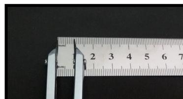
Fig. 13: Traslado de la medida tomada sobre una regla milimetrada.
