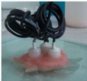
Resina acrílica polimerizando sobre la loseta de vidrio.
