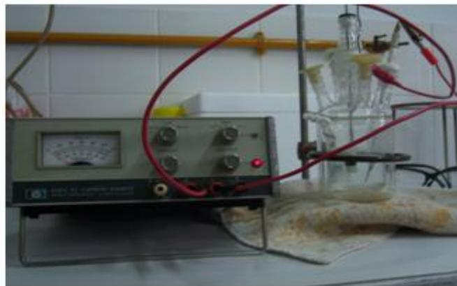
Fig.Nº 26. Fuente conectada a los electrodos, en proceso de anodizado.
