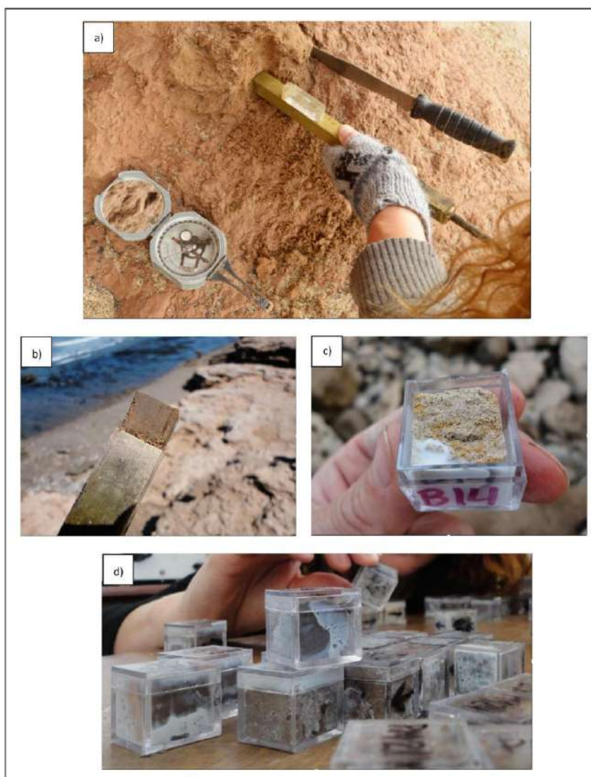
Fig.6.2: Extracción de muestras paleomagnéticas: a) orientación y nivelación del muestreador para extraer material del frente del perfil, b) liberación de la muestra indisturbada, c-d) fijación de la muestra con adhesivo vinílico dentro de portamuestras cúbicos.
