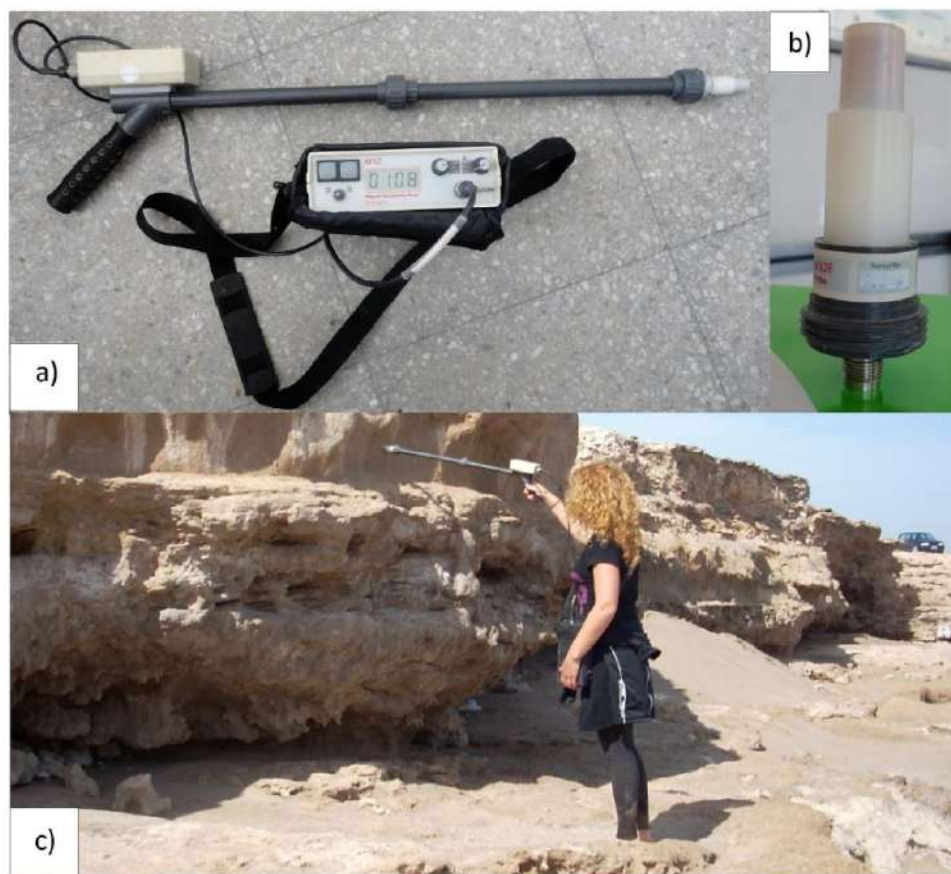
Fig.6.5: Susceptibilímetro de campo MS2 (a), con sensor MS2F (b), para mediciones in situ (c).
