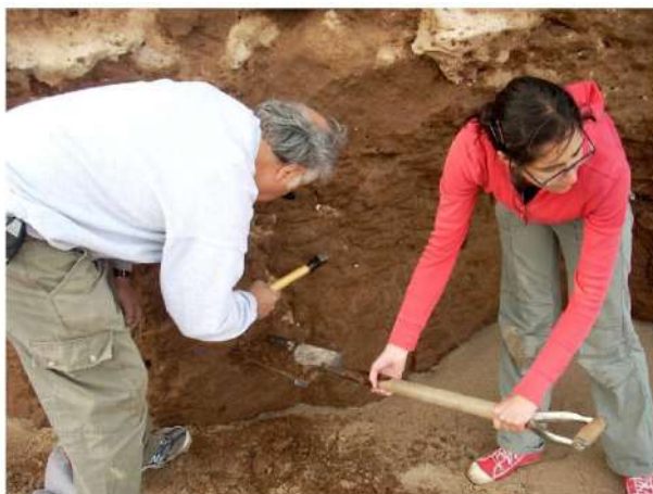
Fig.6.1: Extracción de muestra total con piqueta y pala, para ensayos de laboratorio.
