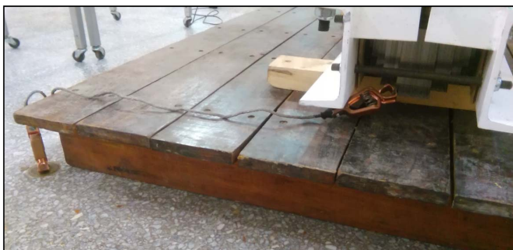
Figura 82: "Puesta a tierra adicional del núcleo".
