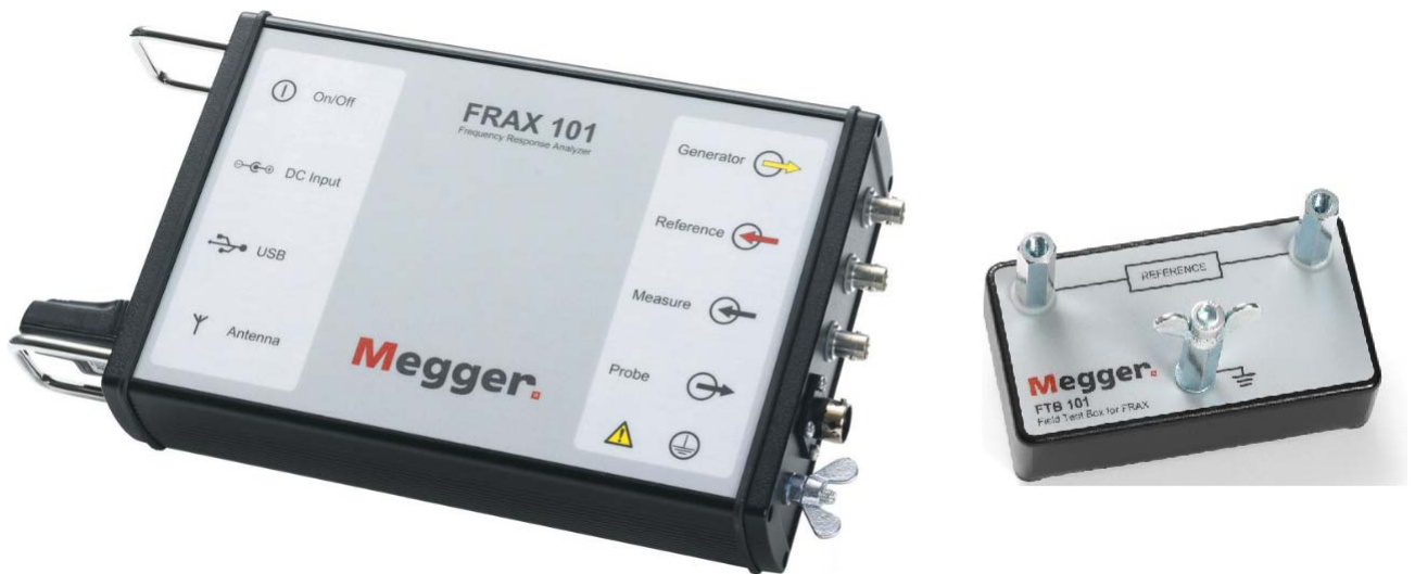
Figura 13: "Instrumento analizador de SFRA y su cuadripolo de referencia".
