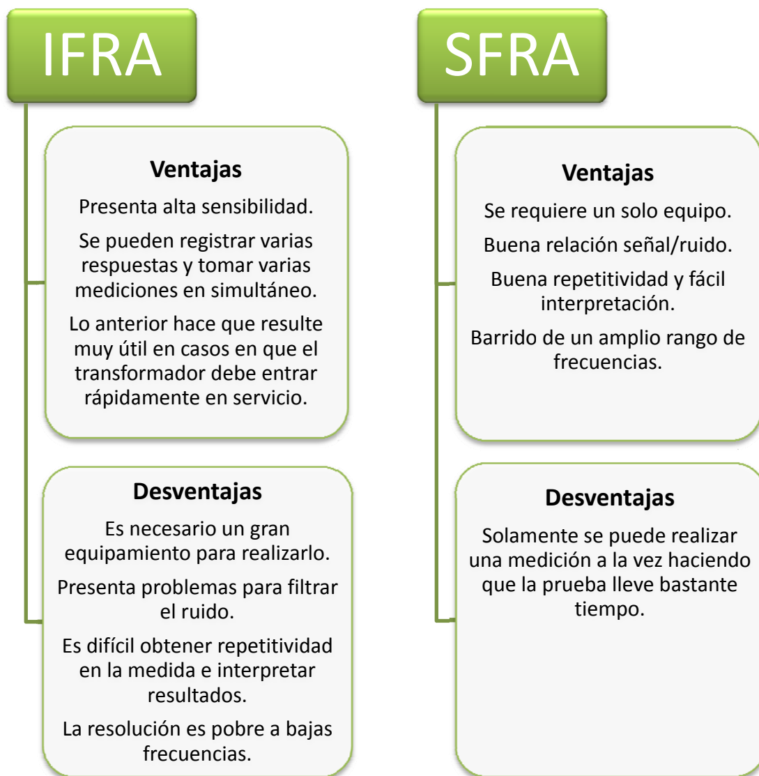
Figura 11: "Comparación entre método de IFRA y SFRA".
