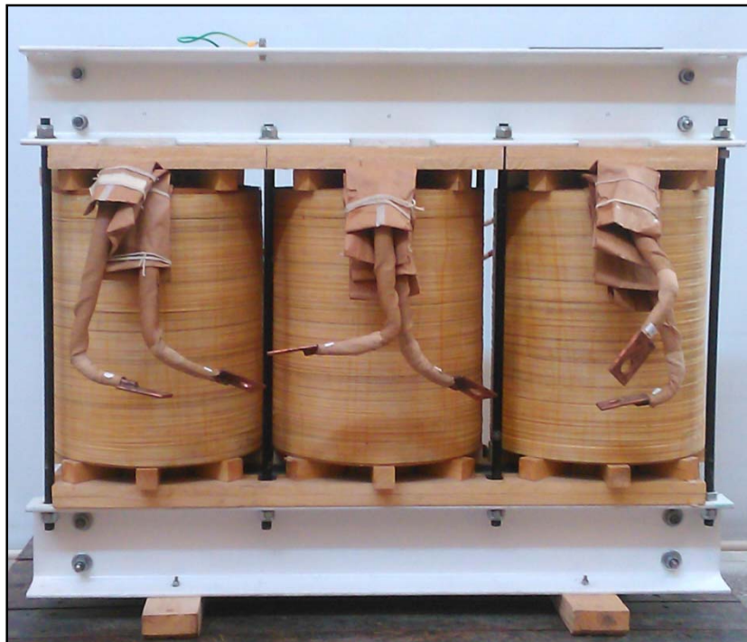
Figura 40: "Vista del lado de BT del transformador".
