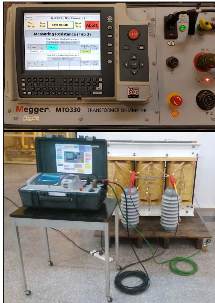
Figura 109: "Equipo y conexiones utilizadas para magnetizar el núcleo".
