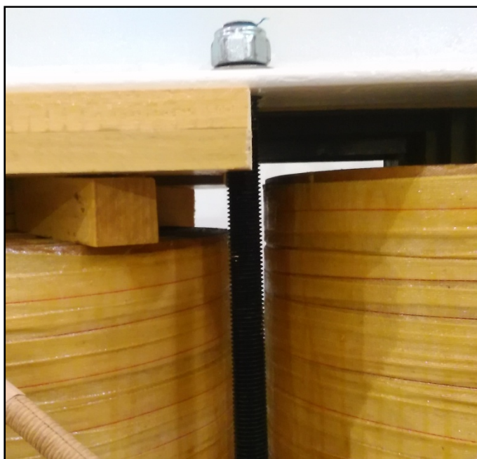
Figura 123: "Comparación de posición entre bobinado central y lateral".
