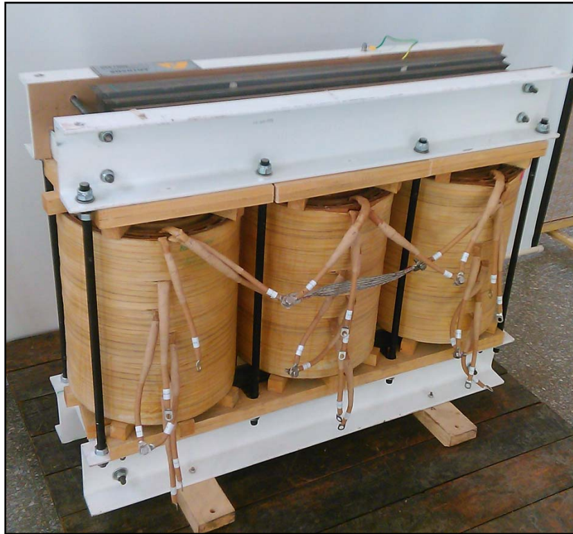
Figura 39: "Vista del lado de AT del transformador".
