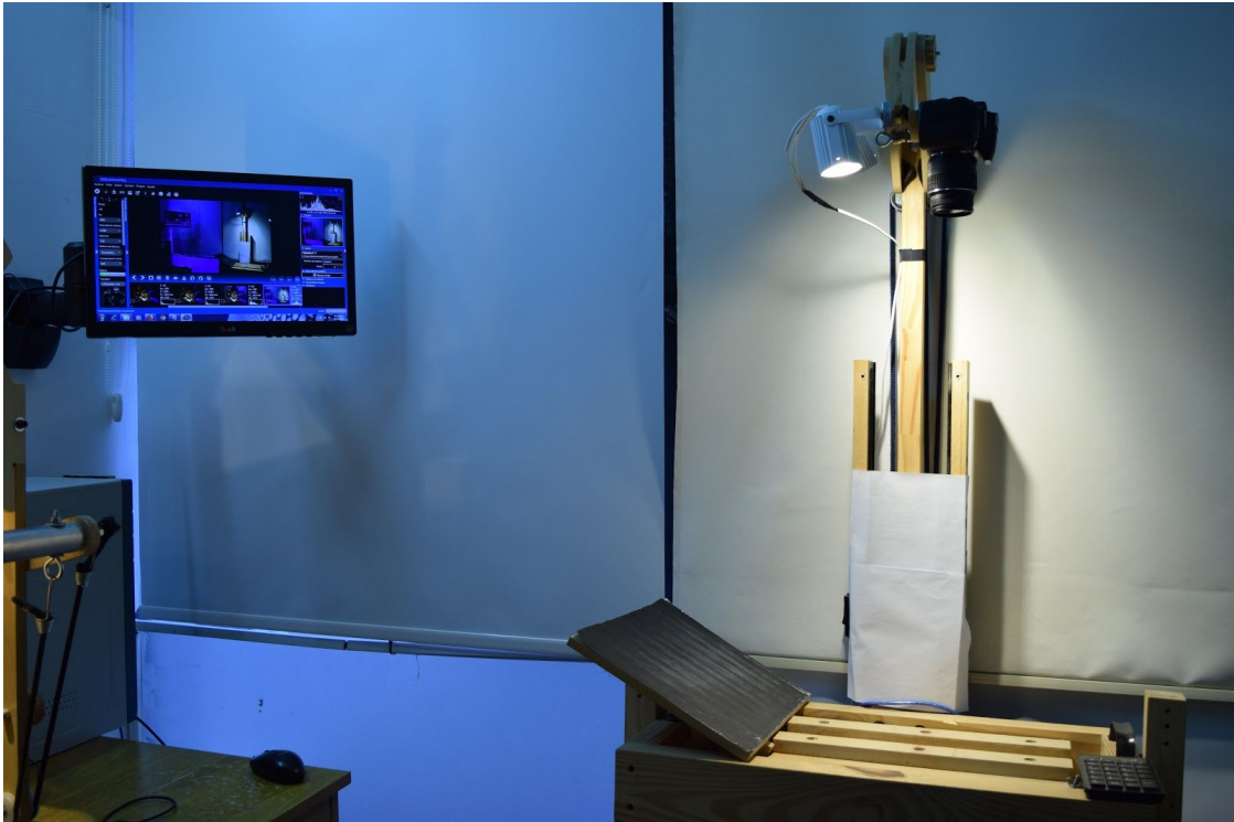
Figura 5. Modelo de escáner con cámara cenital armado especialmente para la digitalización del Copiador del Museo de Física. Se utilizó a modo de atril, para sostener la otra sección del libro sin ejercer mucho peso de ninguno de los lados y tener espacio para girar las páginas sin doblarlas.
