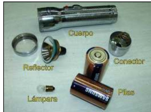
Foto 2 - Componentes de la linterna por separado
