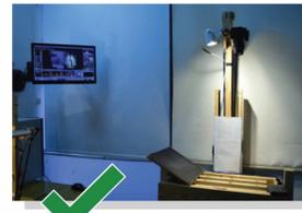
Se optó por un sistema de escaneo rediseñado a partir del Model 1 de DIY, con una cámara cenital apuntando hacia el libro, junto con dos luces LED dicroicas de tonalidad cálida cuya temperatura no daña el material.
