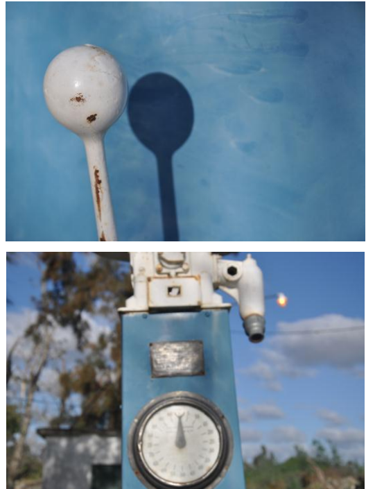
Figura 6: palanca, conexión de manguera y contador del surtidor de combustible.
