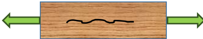
a) Fisura aceptable
