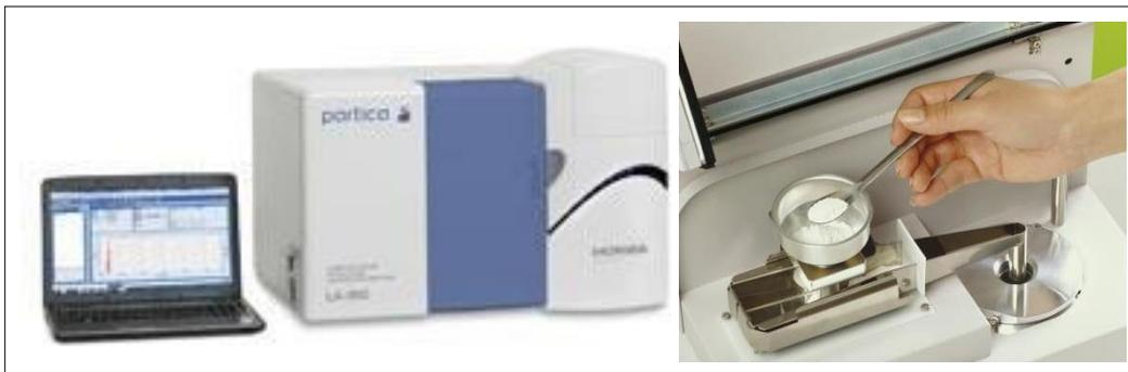
Figura 2.1 Analizador de tamaño de partículas Horiba LA-950. a) vista total del equipo y b) zona de carga de la muestra.
