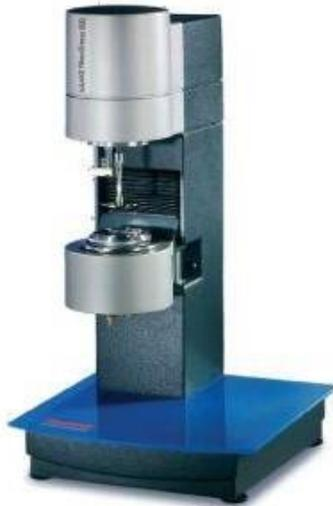
Figura 2.8 Reómetro Haake RS600 con la geometría plato-plato, utilizado para analizar los quesos.
