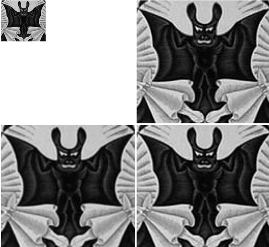
**Fig. 4-176.** Efecto de la interpolación para el aumento de la resolución de la imagen. En el extremo superior izquierdo se ve el detalle original. A su derecha se observa el efecto producido mediante el algoritmo Nearest Neighbor al incrementar 3 veces la resolución inicial. Abajo: el efecto de los algoritmos de interpolación bilineal (izquierda) y bicúbica (derecha).
