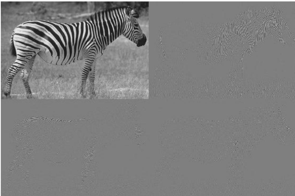
**Fig. 4-102.** Descomposición de una imagen real mediante la transformada *wavelet* en una sola iteración.
