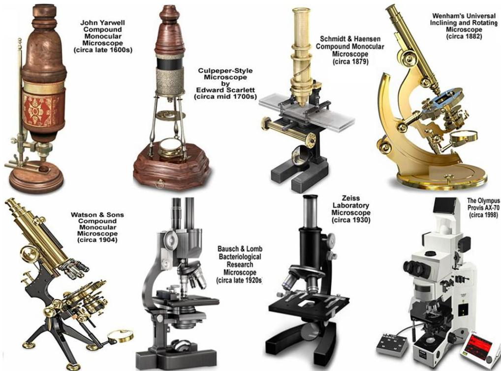
**Fig. 3-5.** Evolución de los microscopios compuestos.
