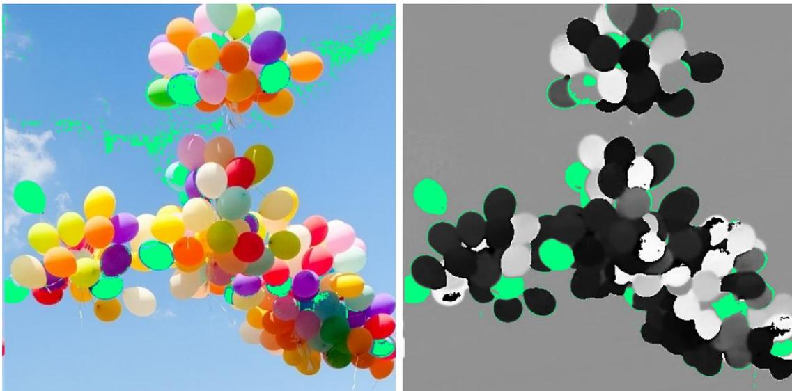
**Fig. 7-48.** Segmentación de la tonalidad celeste sobre una imagen RGB (izquierda) y sobre el canal H en una imagen HSI (derecha).
