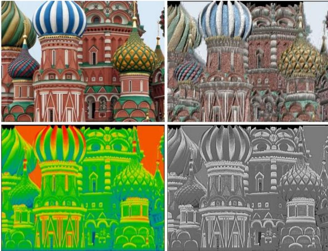
**Fig. 6-91.** Representación isométrica de la superficie de la imagen, que refleja las intensidades de sus píxeles. Los píxeles claros están sobreelevados, mientras que los oscuros se deprimen. Este efecto se observa tanto utilizando los colores reales de la imagen (arriba derecha), como los de paleta (abajo izquierda) o las intensidades monocromáticas (abajo derecha).
