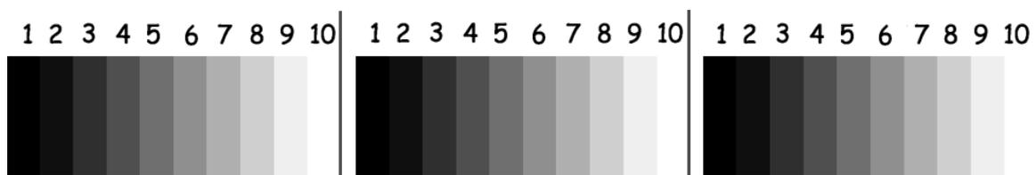
**Fig. 4-190.** Conversión de la imagen original de 8 bits (izquierda) en 12 bits (centro) y 16 bits (derecha) mediante el escalado directo. La apariencia de todas las imágenes es la misma. Los encabezados de cada columna sirven como referencia para los valores listados en la Tabla 4-2.
