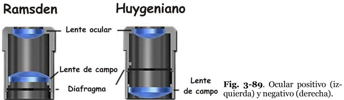
**Fig. 3-89.** Ocular positivo (izquierda) y negativo (derecha).
