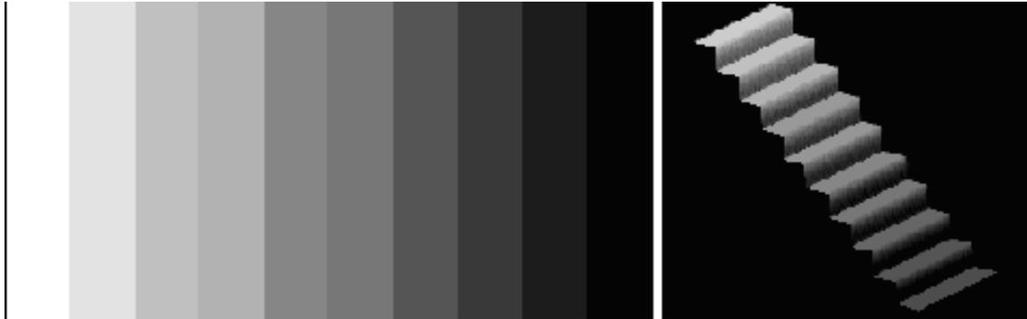
**Fig. 1-16.** Patrón de escalonamiento de diferentes intensidades de gris. Cada escalón contiene la misma intensidad de luz a lo largo y a lo ancho. A la derecha, se observa gráficamente el patrón de escalonamiento, en función de la intensidad de luz.
