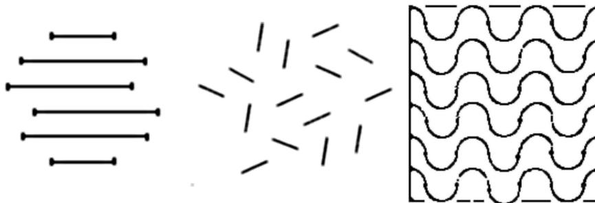
**Fig. 6-7.** Grillas estereológicas. De izquierda a derecha: Zeiss II; Weibel I; Merz.
