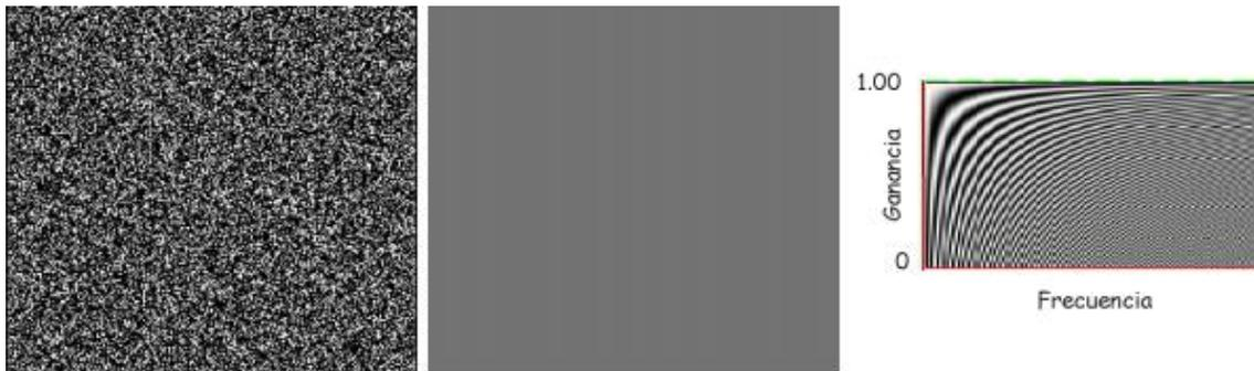
**Fig. 4-83.** Sobre una imagen representativa de ruido estático (izquierda) se aplicó el filtro espectral grande de Paso de Banda (centro). El *kernel* de HiPass fue de 63x63, mientras que el de LowPass fue de 232x232, durante 20 pasajes. Las partículas de ruido fueron eliminadas y se incrementó la intensidad. El espectro (derecha) muestra una curva ideal.
