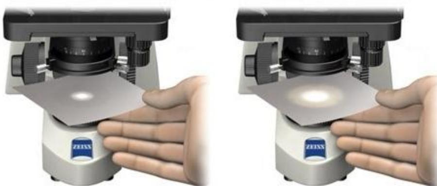
**Fig. 3-136.** Configuración del microscopio para lograr la iluminación Köhler. Izquierda, observación de la luz que emana del diafragma de campo, con su mínima abertura. Derecha, abertura total del diafragma de campo.
