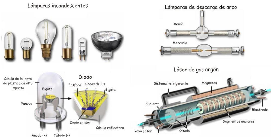
**Fig. 3-20.** Diferentes fuentes de luz: lámparas incandescentes, descarga de arco o gas, diodos y láser.
