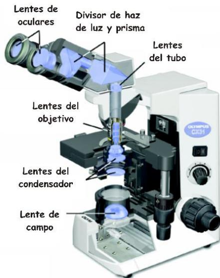
**Fig. 3-57.** Estructura del microscopio de luz, mostrando distintos tipos de lentes interpuestas en el camino óptico.
