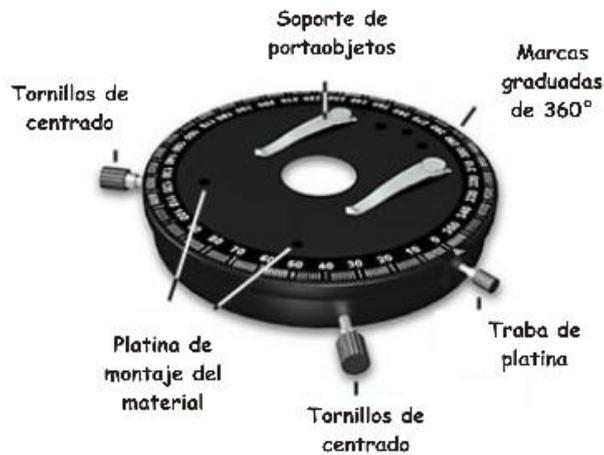
**Fig. 3-91.** Platina mecánica circular.
