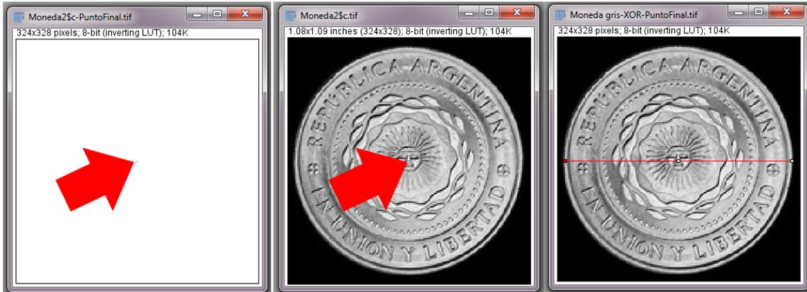
**Fig. 7-6.** Reducción de la moneda mediante el filtro Punto final (izquierda). La imagen monocromática (centro) fue invertida para relacionarla con la imagen anterior, mediante el conector lógico XOR. La flecha roja en ambas imágenes indica la posición exacta del punto. A partir de allí, se puede trazar cualquier línea desde los extremos de la moneda, que pase por el punto central (derecha).
