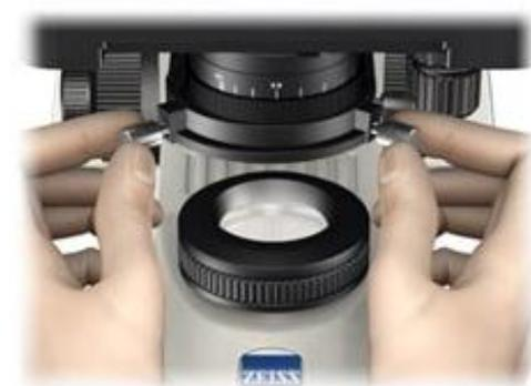
**Fig. 3-137.** Centrado del condensador utilizando los tornillos de centrado.
