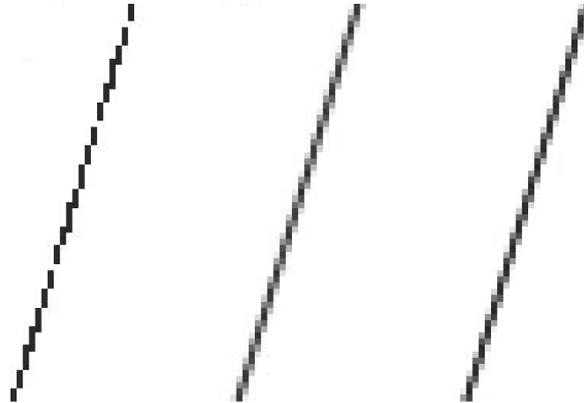
**Fig. 4-172.** Al rotar una línea de un píxel de ancho de color negro, el efecto final dependerá del método utilizado. A la izquierda se ve el efecto de la rotación por el método de Nearest Neighbor. En el centro se ve el efecto de la interpolación bilineal y a la derecha el de la interpolación bicúbica. Estos dos últimos métodos agregan grises a lo largo del eje para suavizar el efecto de la rotación.
