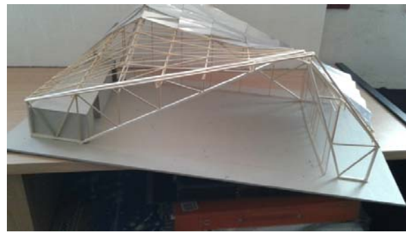
Fig. 5 y 6– Vista de la estructura de grandes luces y maqueta de la propuesta esc. 1:50
