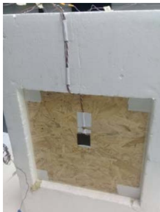
Cara “fría”. Medidor de flujo.
