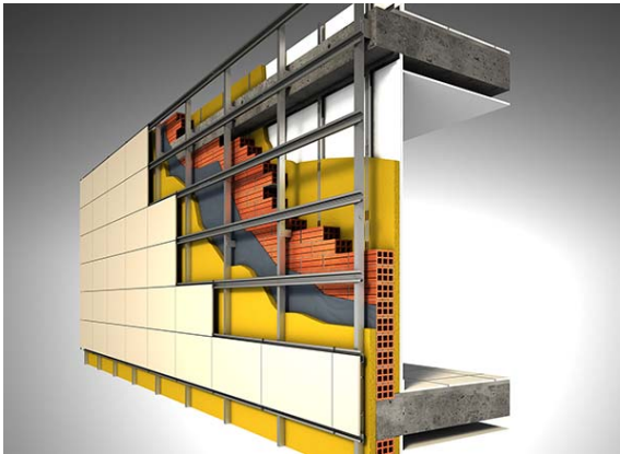
Fig. 2 Hoja exterior de grandes piezas de gres cerámico. Fuente: Internet.
