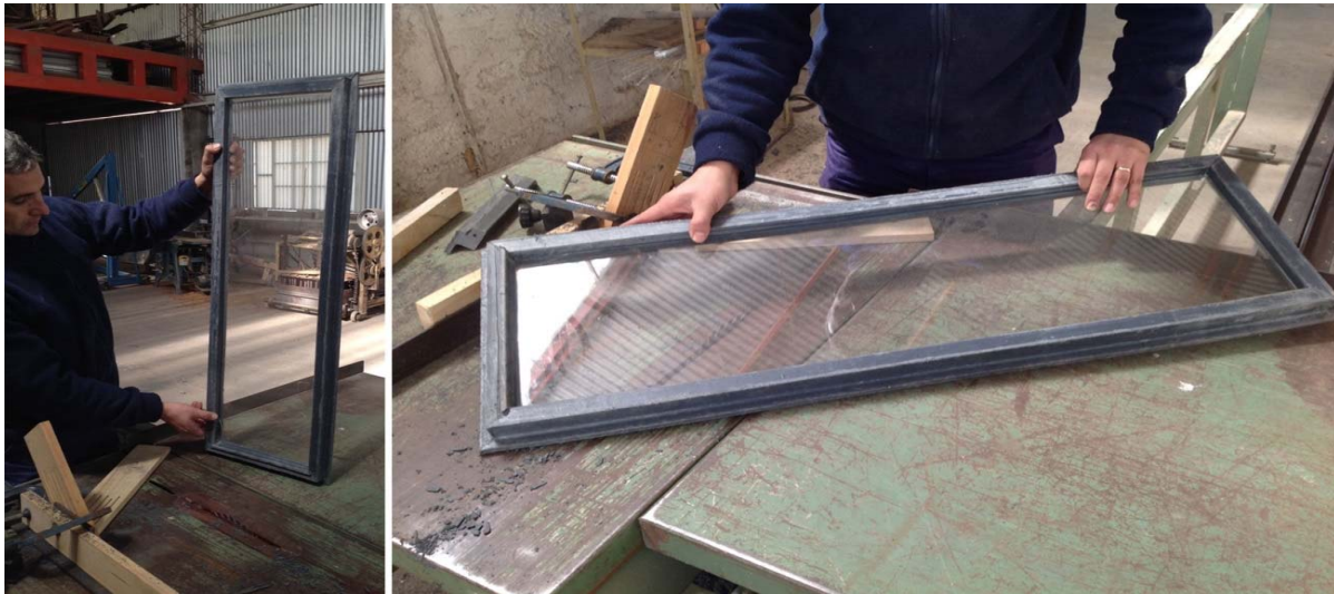
Fig 11. Prototipo de marco de ventana de perfilera de plástico reciclado.
