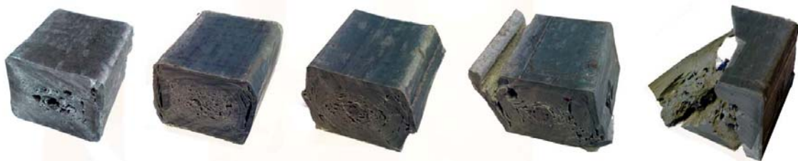
Fig. 6. Probetas ensayadas de formulación F1 a F5.
