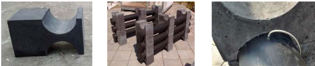
Fig. 4: Piezas de "tubo simple", vista del sistema armado y detalle de la instrumentación.
