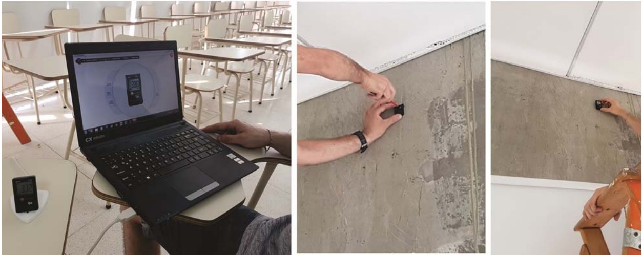
Fig.7 Dispositivo Testo 174H Data Logger anclado al muro del aula de estudio.
