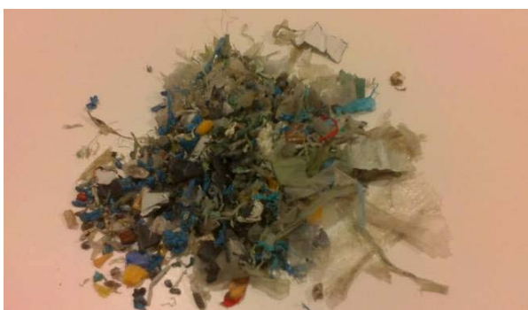
Fig. 3: Triturado de restos de polietileno (imagen Zicla)
