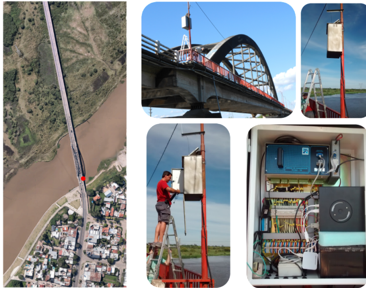
Figura 8. Estación del SAH en Santo Tomé - Implementación de prototipos.
