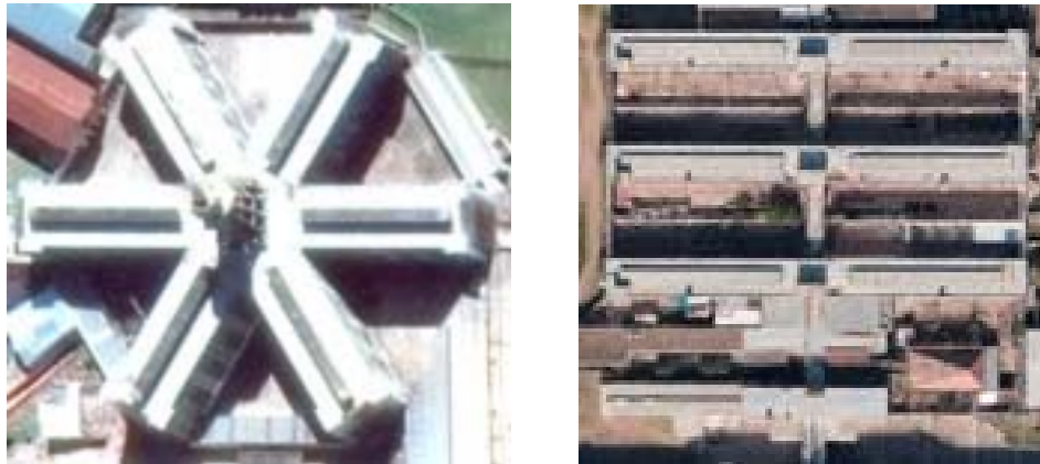
Fig. 2. Esquema Radial Unidad 01-Olmos-LP/ Esquema Paralelo Unidad 09 La Plata.
