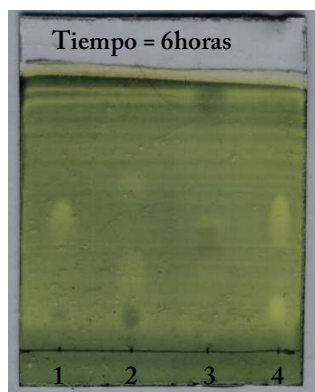
Figura 4.2: Análisis por TLC de la reacción Bz-Arg-OEt con Glicinol en ACN 0,25% H 2 O. Punto de siembra 1: patrón de sustrato (Bz-Arg-OEt). Punto de siembra 2: patrón de sustrato hidrolizado (Bz-Arg-OH). Punto de siembra 3: muestra de reacción. Punto de siembra 4: blanco de enzima.
