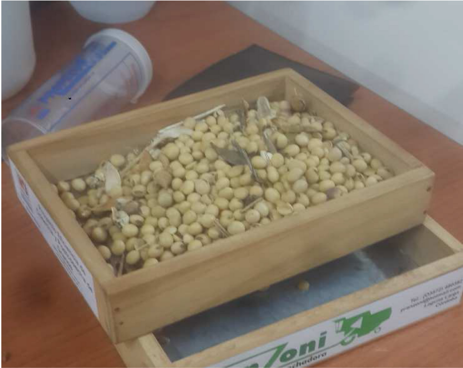
Imagen N° 12: Bandeja zaranda cargada donde se observan algunas mitades en la bodega ciega inferior.
