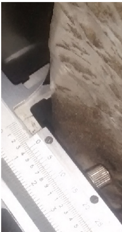
Imagen N° 8: Luz pared-sinfín del tubo de descarga de la cosechadora.
