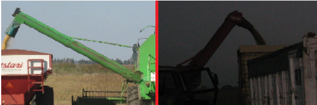
Imagen N° 7: Comparación del ángulo de inclinación de los tubos de descarga de la maquina cosechadora y la monotonlva.
