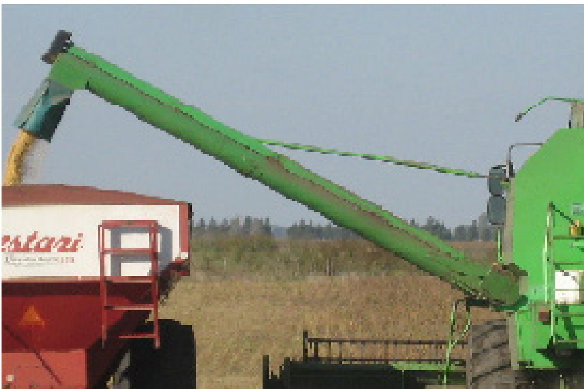
Imagen N° 10: Vista del ángulo de inclinación del tubo de descarga de la cosechadora.
