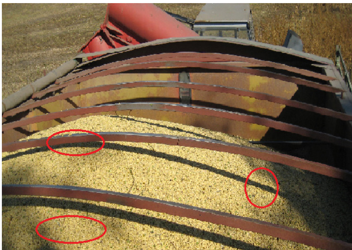
Imagen N° 6: Toma de muestras en tres puntos diferentes dentro de la monotolva.
