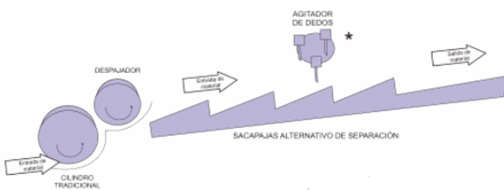
Imagen N° 3: Sistemas de trilla y de separación de la cosechadora utilizada para el trabajo.
