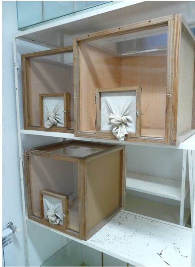
Figura 2. Jaulas para el mantenimiento y la alimentación de hembras de Ochlerotatus albifasciatus .
