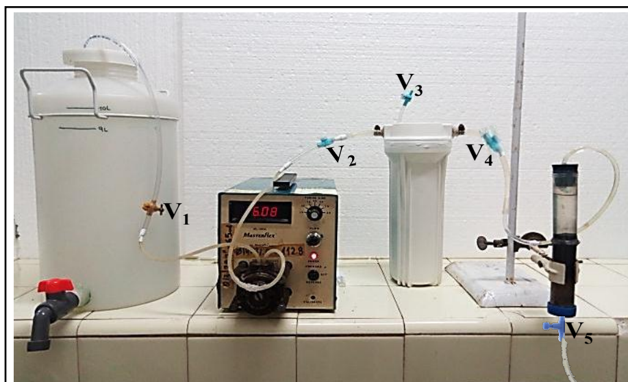
Figura 9.5. Diseño final de la columna de adsorción a escala de laboratorio.
