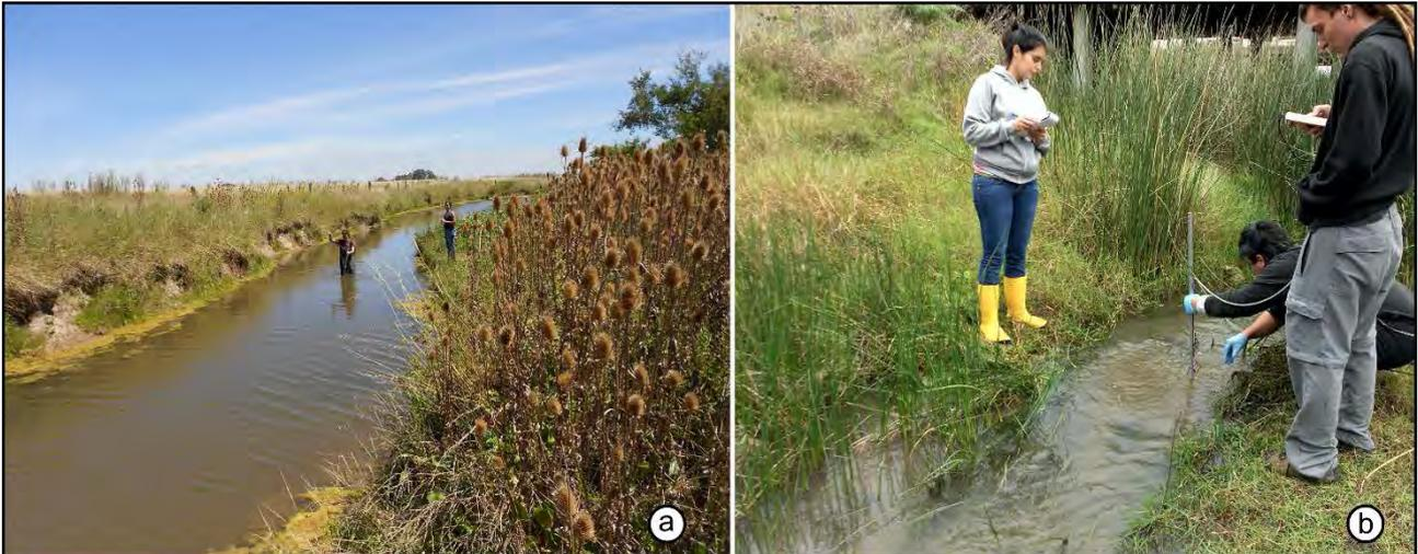
**Figura 2.4.** Trabajo de campo. Medición de caudal con el molinete hidrométrico en el arroyo Buñirigo. **(a)** Cuenca alta. **(b)** Cuenca baja.
