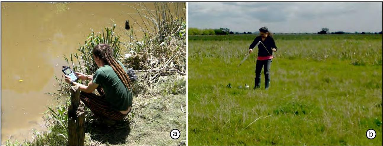
**Figura 2.3.** Trabajo de campo. **(a)** Medición de la conductividad eléctrica y temperatura del agua en la cuenca baja del arroyo Buñirigo con el equipo portátil. **(b)** Toma de una muestra de agua subterránea con un muestreador de tipo bailer en el Establecimiento Juan Blanco.
