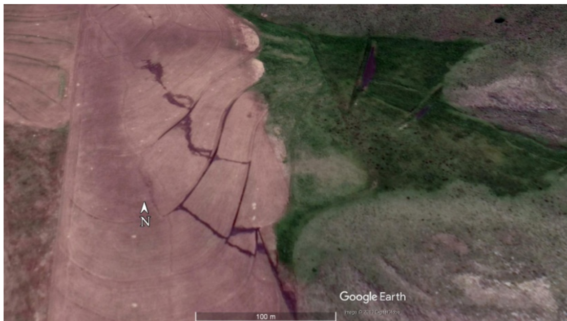
Foto N°1: F: Cárcava y escurrimiento superficial en medidas de conservación.
