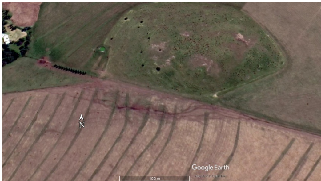
Foto N°1: D: Cárcava y escurrimiento superficial en medidas de conservación.
