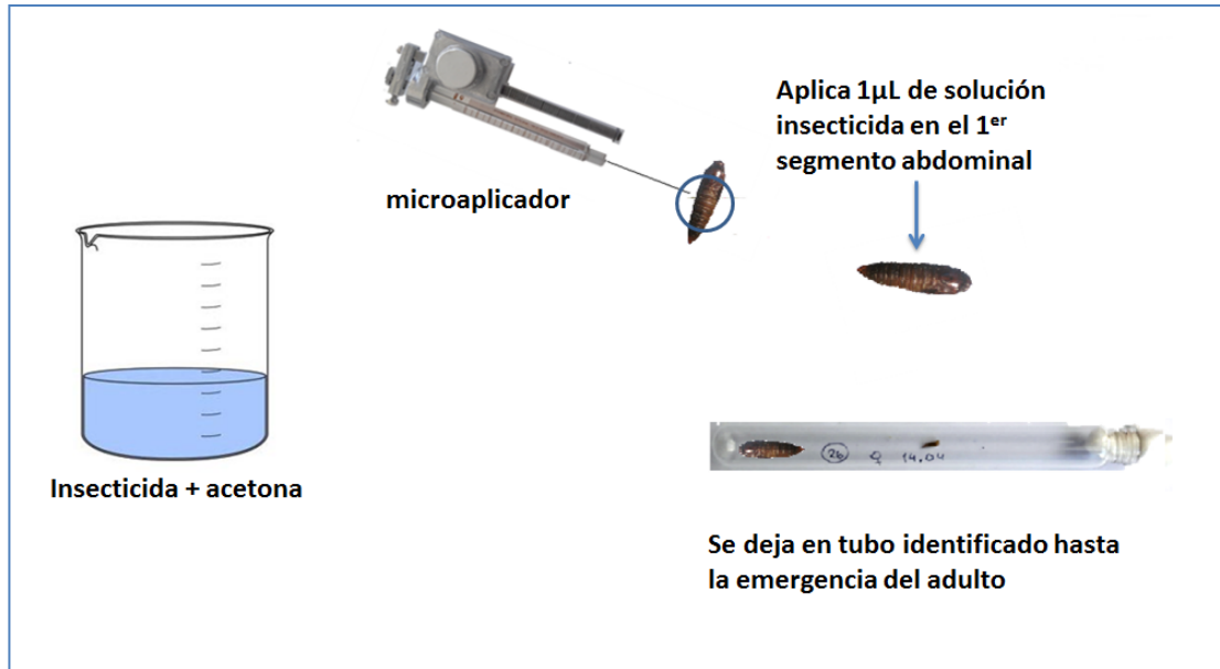
Figura 6. 2. Esquema de la metodología empleada para la aplicación tópica de los insecticidas sobre pupas de Lobesia botrana .
