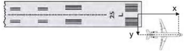
**Fig. 12:** Ejes de Coordenadas utilizados para el modelo probabilístico. Fuente: elaboración propia
