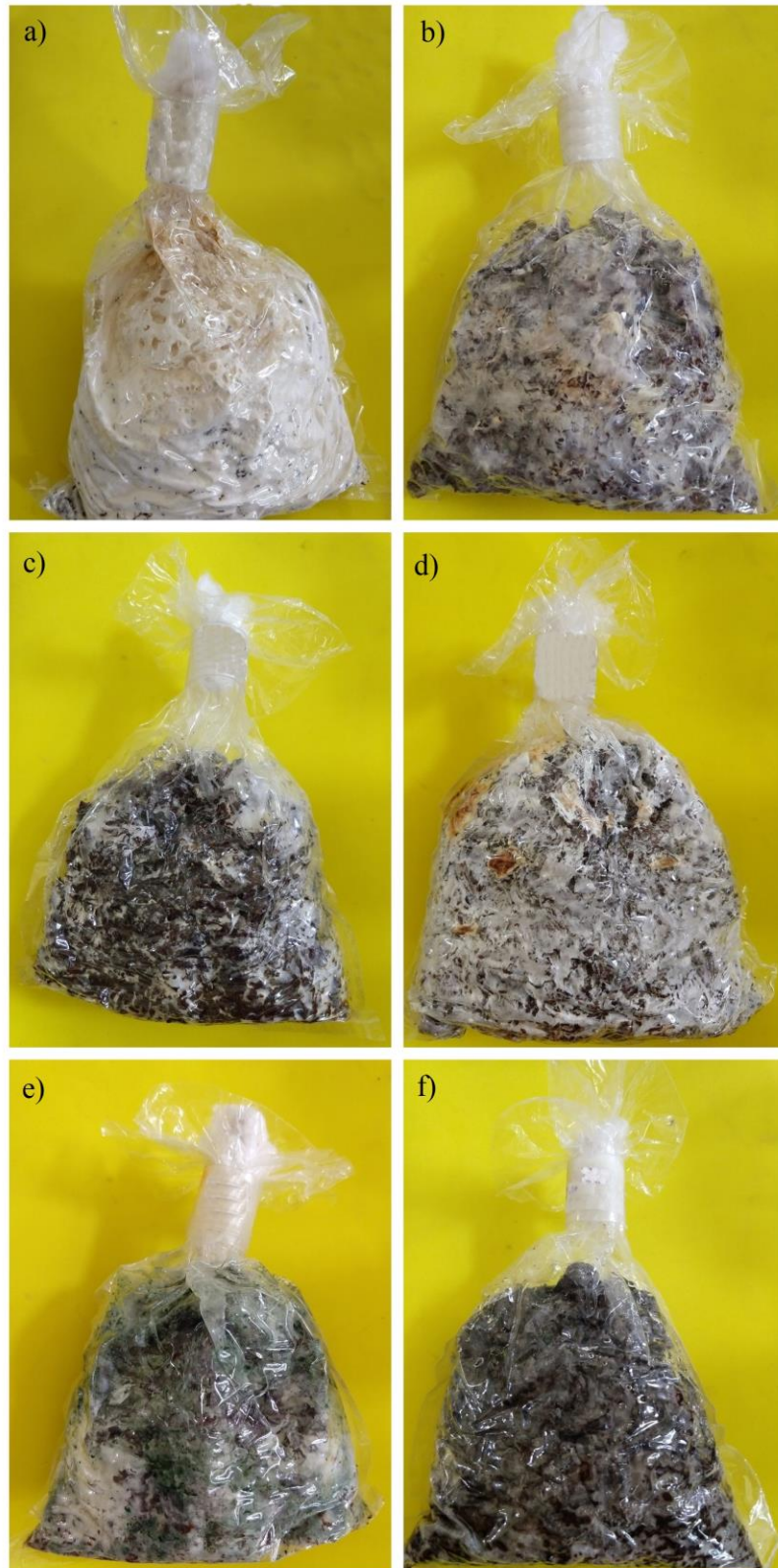
Fig. III.4 – Colonización del orujo de uva por los hongos saprótrofos después de 90 días de incubación bajo condiciones de FES: (a) C. rigida , (b) G. sepiarium , (c) P. albobadia , (d) P. sanguineus , (e) T. harzianum y (f) U. botrytis .
