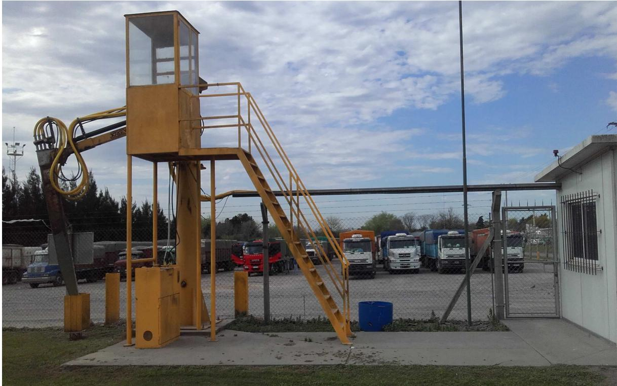
IMAGEN 5: Calador hidráulico junto al ingreso de camiones. Pertenece a establecimiento elaborador en Provincia de Buenos Aires
