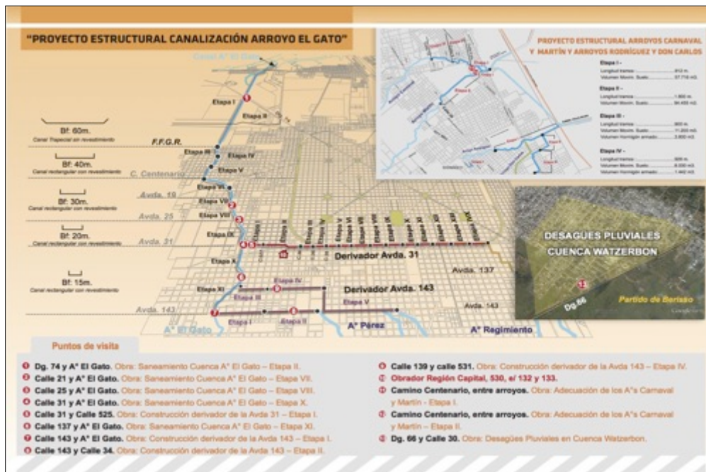
Plano de obra de la canalización del arroyo El Gato, indicando tramos y cantidad de metros de ampliación por tramo. Obtenido del sitio web de la Comisión Bicameral de Control y Fiscalización de las Obras ( www.obrasregioncapital.com ). Consultado el 1 de junio de 2015.
