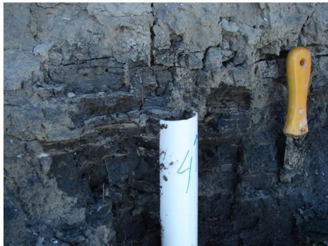
Foto 2.2. Metodología de muestreo de testigos continuos mediante el uso de tubos PVC.
